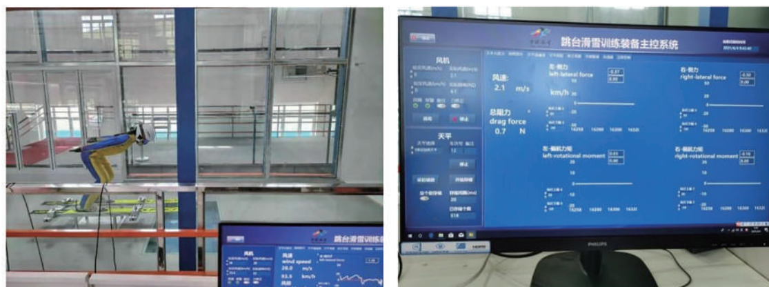
图2 水平试验段测试示意图
