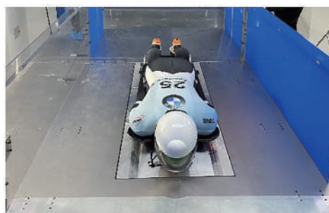
图4 钢架雪车风洞实验状态
